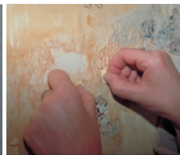
Afb. 27 De kleefband wordt aangebracht op een verdacht oppervlak en dan op een glazen plaatje gelegd.
