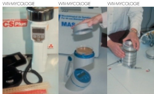
Afb. 34 Drie voorbeelden van impactoren die gebruik maken van strips of Petrischalen, die gevuld worden met een gelatineachtig milieu.
