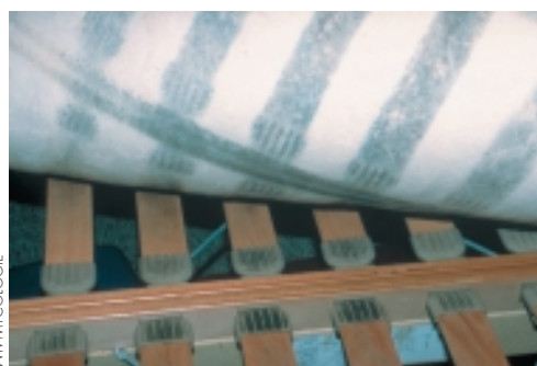
Afb. 22 Ontwikkeling van schimmels ( Cladosporium sphaerospermum ) op plaatsen waar de matras de lattenbodembodem raakt.
