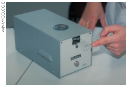
Afb. 32 Voorbeeld van een draagbare impactor met transparante, klevende glazen plaatjes.
