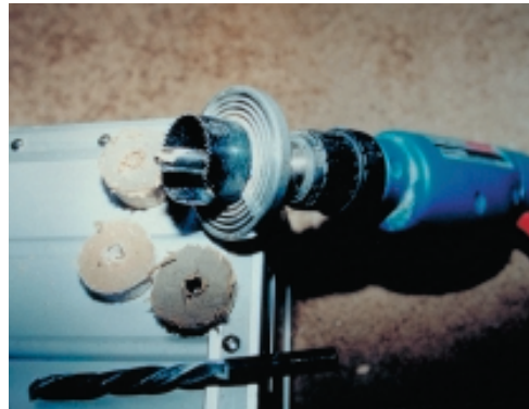
▲ Afb. 24 Nemen van kernen in een holle wand met een klokboor.
